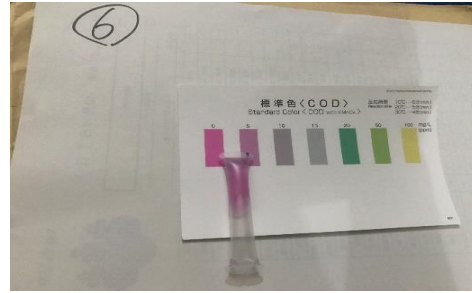
試薬を用いた水質検査の様子
